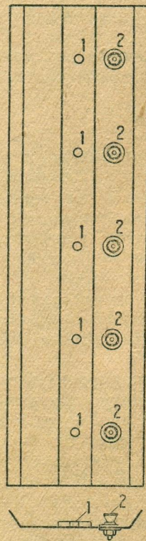
Рис. 30. Разметка на днище камеры аппарата типов СКА-1 или СКА-2 для установки патронов „Голиаф“ для ламп типа Игар и клемм для вспомогательных электродов (в масштабе) 1—отверстия для ниппелей патронов, 2—клеммы для присоединения вспомогательных электродов
