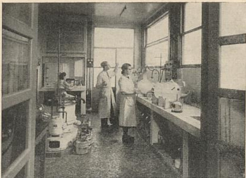
Vue partielle d'un laboratoire de chimie, où sont préparés les enduits des cathodes, les getters, les métallisations, etc. Une autre section est réservée à l'analyse des matières premières
