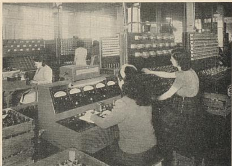
Le contrôle final des tubes terminés. Avant d'être emballés, les tubes subissent une série de contrôles pour vérifier les caractéristiques et la qualité du vide. Un certain pourcentage est prélevé périodiquement pour subir les épreuves de durée.
