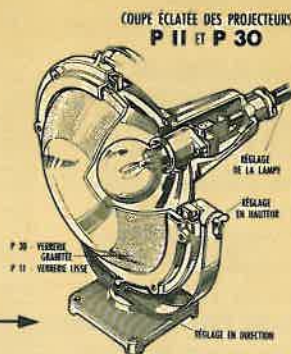
Position d'utilisation des lampes pour projecteurs P 11 et P 30
