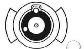
K59d mit flexiblem Siaf-Kabel Kabellänge 350 mm Kabelschuh-Loch Ø 8,4 mm DIN 49732
