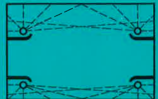
Bild 4 Indirekte Entkeimung durch Wandstrahler bzw. direkte Bodenentkeimung
