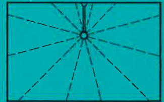
Bild 3 Direkte Entkeimung durch Pendelstrahler
