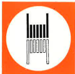
Spiegelbildeinstellung bei Lampen mit Flachkernwendel-Leuchtkörper
